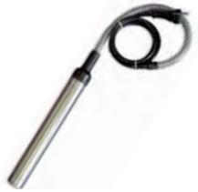
Zur Wassertemperierung, als Frostschutz in Nassschneidemaschinen oder zur Erwärmung von Lehm, wasserdichter Edelstahltauchheizkörper zur Erwärmung von nicht brennbaren Flüssigkeiten, anschlussfertig mit 2 m Kabel und Schukostecker, lange Lebensdauer, leicht zu reinigen, ein eingebauter Thermoschalter begrenzt die Wassertemperatur auf ca. 40°C.
